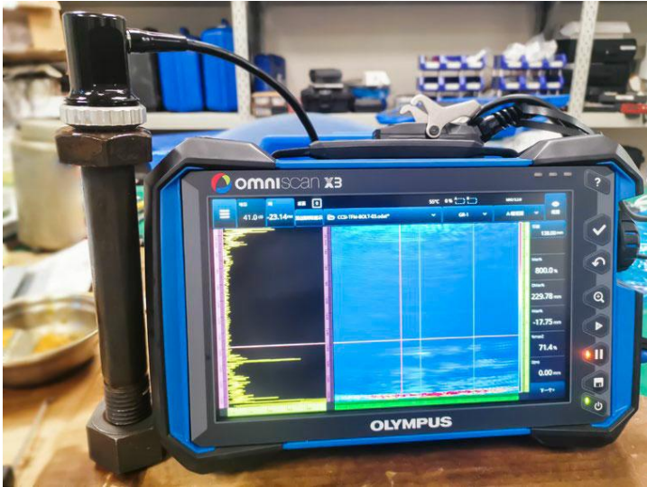
图1. OmniScan X3探伤仪与螺栓上的环阵探头相连
