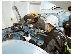
图1：观察齿轮箱的内部 风力发电机检测人员通过使用视频内窥镜，可以迅速有效地探测到齿轮箱的损伤情况。
