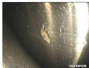
図3：スポットライトの照射 優れた照明により、暗い空間での欠陥検出能力が向上します。
