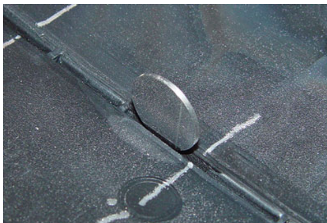
図3：破断部位の内側に配置されたターゲットディスク。
