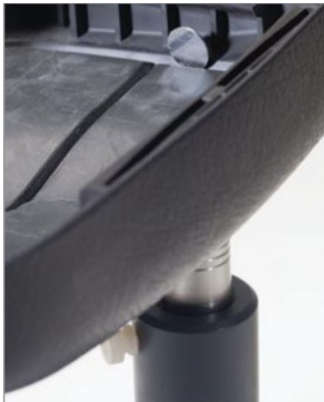
図2：エアバッグカバーの外側に配置されたプローブ。
