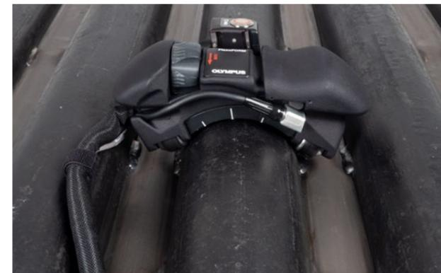
FlexoFORM扫查器还可以在纵向上对管道进行检测。在检测较小的管道或检测区域集中在管道周向上特定的区域时，这种扫查配置特别有用。在这些情况下，使用平面相控阵探头沿着管道的纵轴进行检测比在管道周向上进行扫查更有效。FlexoFORM扫查器还是检测发电站锅炉水冷壁的一种强大的工具。
