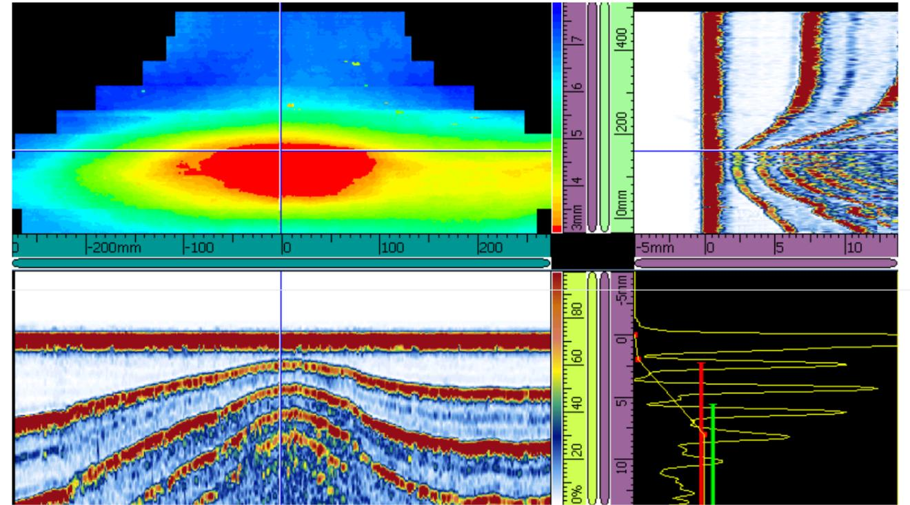
这种解决方案在扫查方向上进行编码，而且扫查器上直接装有一个步进按钮，可以在次轴方向上进行步进增量操作，以在同一个文件中创建2维表面图像。
